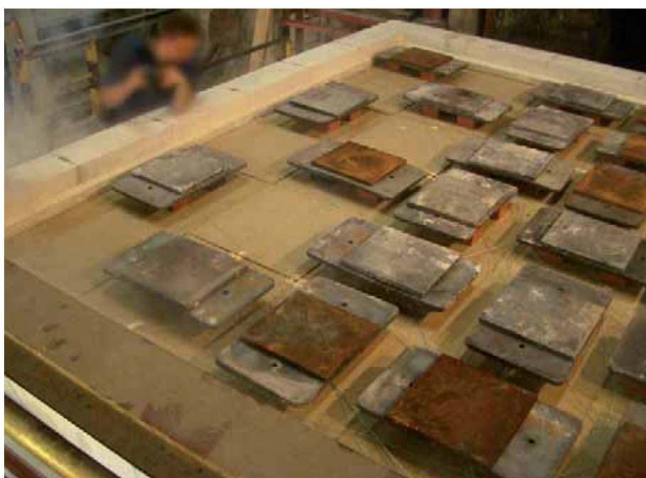
Essai de résistance au feu d'un plancher surélevé selon DIN 4102/2.
